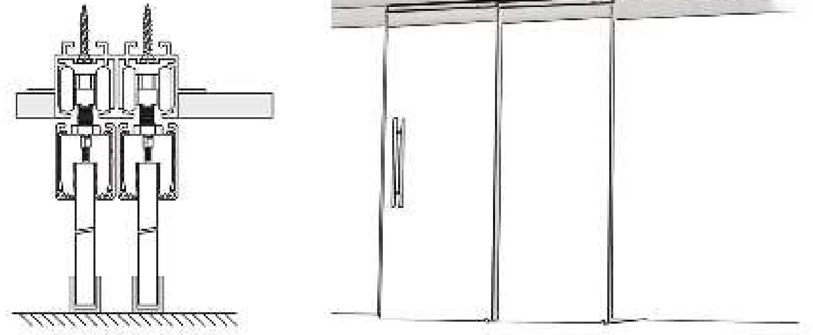
Sistema Scorrevole Con Binario A Scomparsa "TSC200" due o quattro ante parallele con anta fissa
